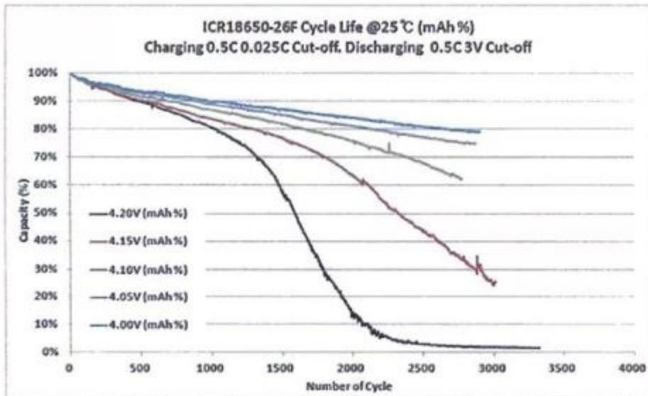
→ je niedriger die Ladeschlussspannung gesetzt wird, desto länger die Lebensdauer
